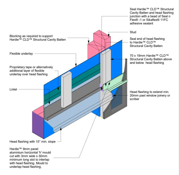
jhl\_axon24\_c\_041 jhl\_axon24\_c\_ktaltd.rvt Axon™ Panel JamesHardie<sup>®</sup> Hardie™ CLD™ Batten With Flexible Underlay
